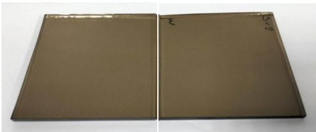
Figure IV.2 : La variation de l'indice de couleur après 21 jours de test, A : coté film ; B : coté glass.
