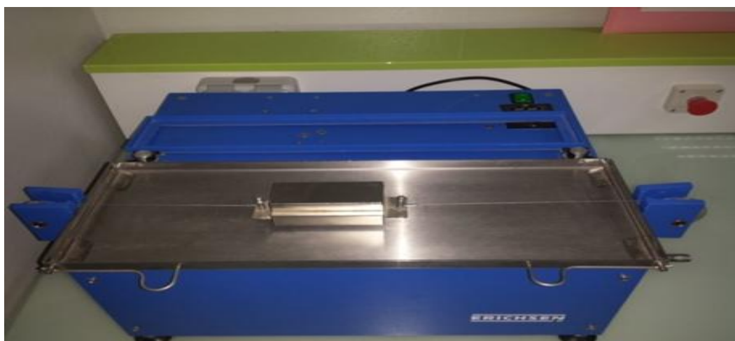
Figure III.5 : L'appareil de contrôle de la dureté et de l'abrasion Erichsen modèle 494.
