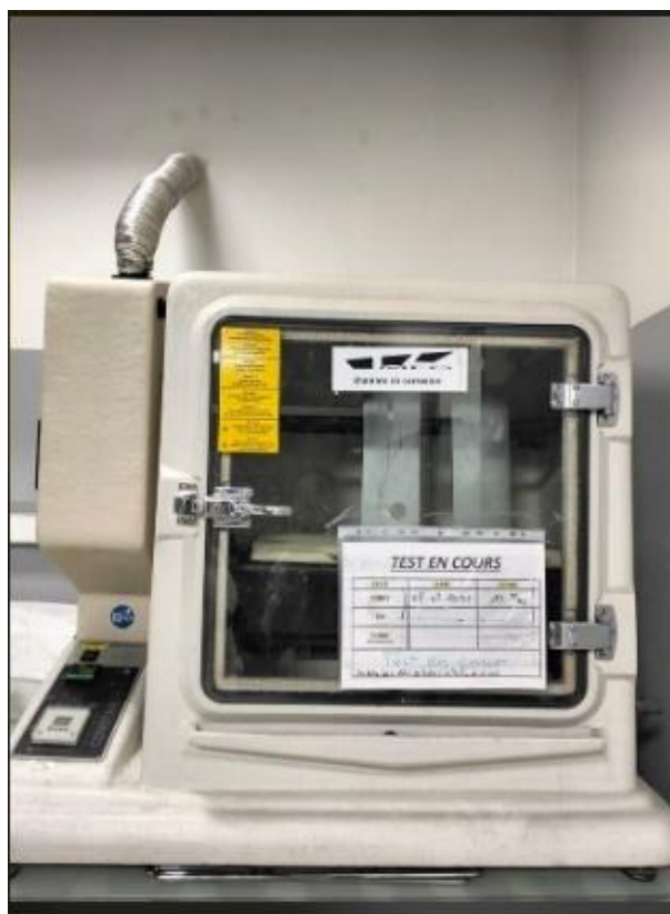
Figure III.3 : Dispositif expérimental de test de corrosion.
