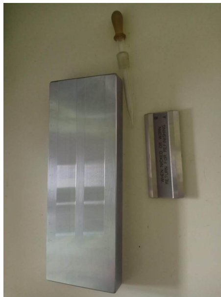
Figure II.15 : L'appareil de contrôle la conformité de suspension « Jauge de Hegman ».
