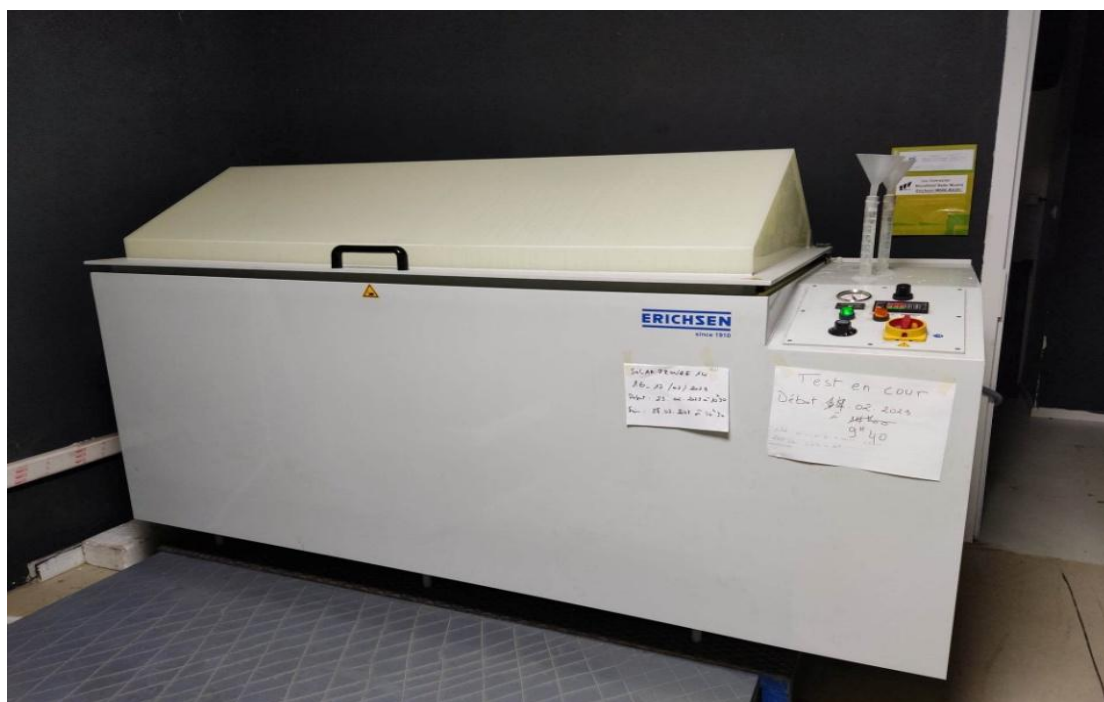
Figure III.2 : Le brouillard salin neutre-NSS utilisé dans ce test.
