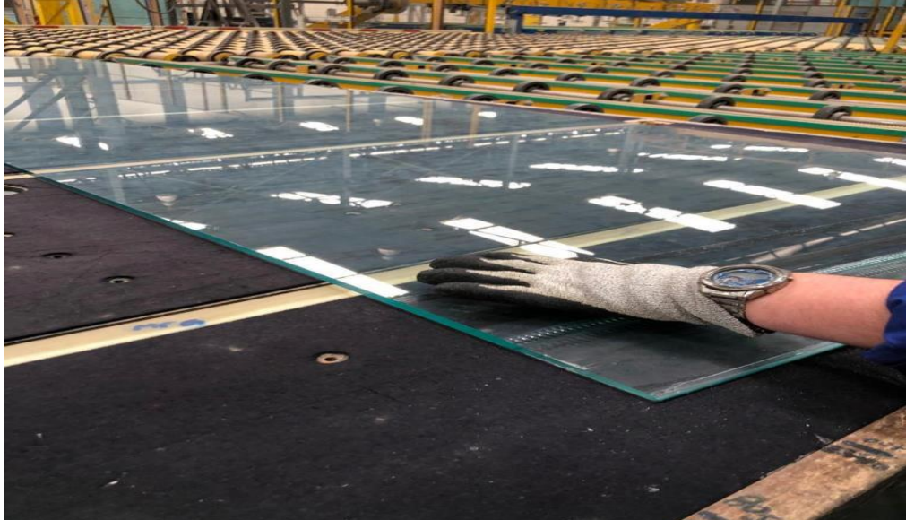
Figure II.8 : La méthode d'enlèvement des bords du ruban.
