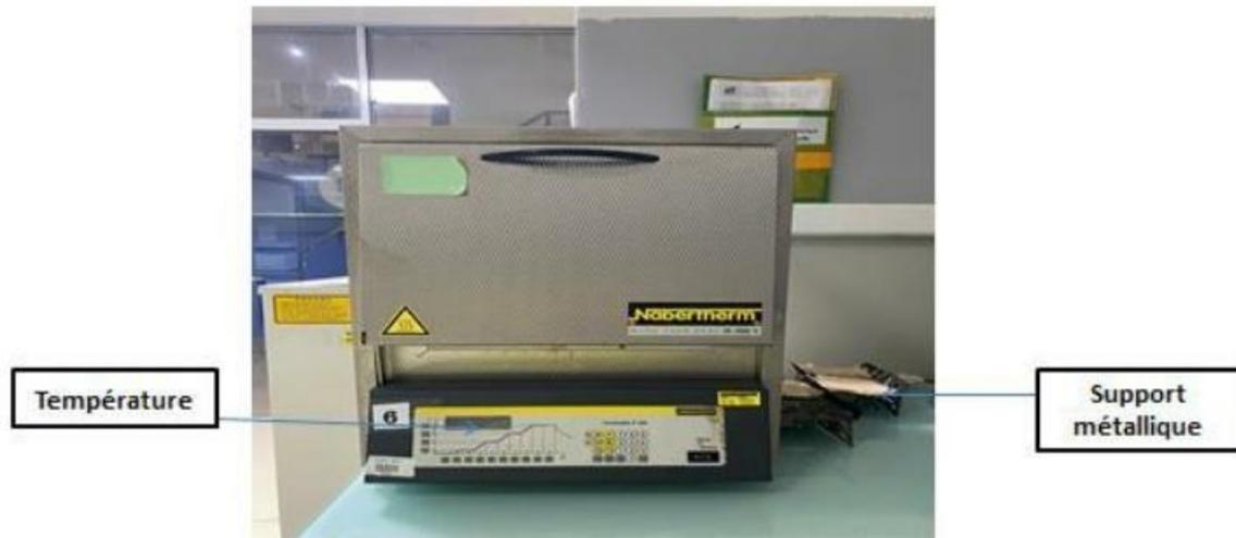
Figure IV. 4 Four à moufle utilisé pour le teste de trempe thermique
