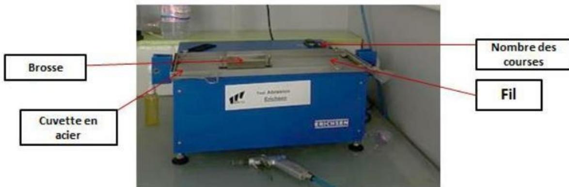
Figure IV. 5 Abrasimètre modèle ERICHSEN 494
