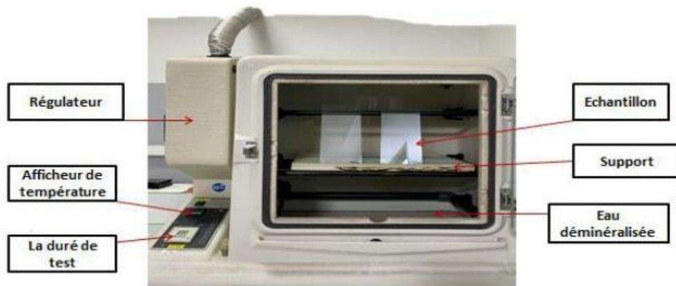
**Figure IV. 6** Chambre de corrosion
