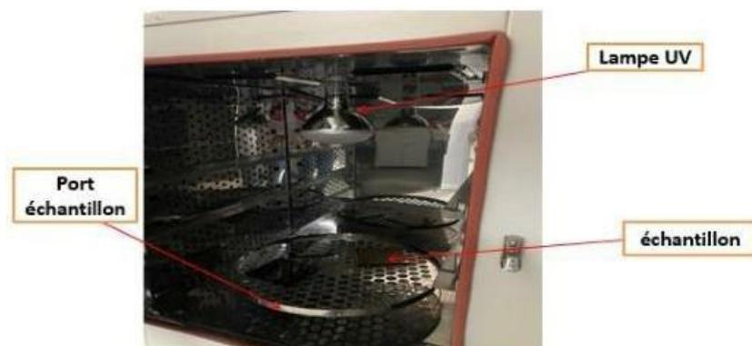
Figure IV. 2 Chambre « UV » de test de Vieillissement
