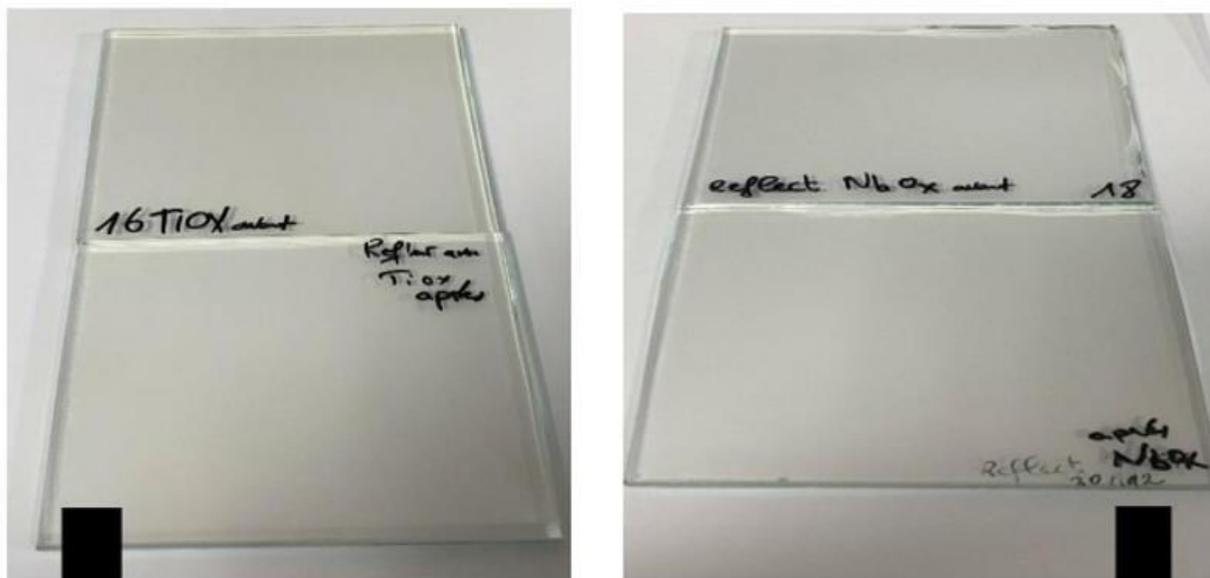
Figure V. 4 Comparaison des échantillons avant et après test brouillard salin
