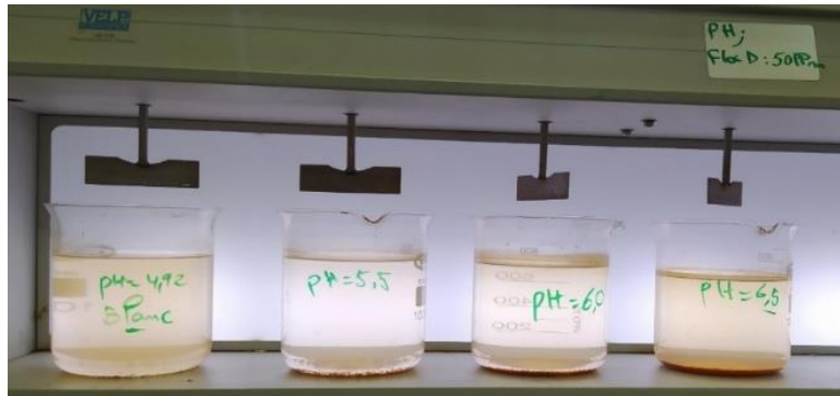
Figure 4-12: Photo représentant les résultats de la floculation en présence de 50 ppm du polymère commercial en fonction du pH après 30 minute de repos.
