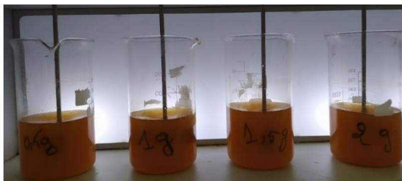
Figure 4-24: Photo d'effet de différentes masses de billes de chitosane après 5 min de contacte.
