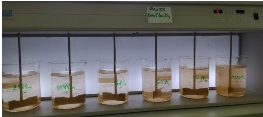
Figure 4-16: Photo représentant les résultats de la floculation à pH fixe après 15 minute de contact.
