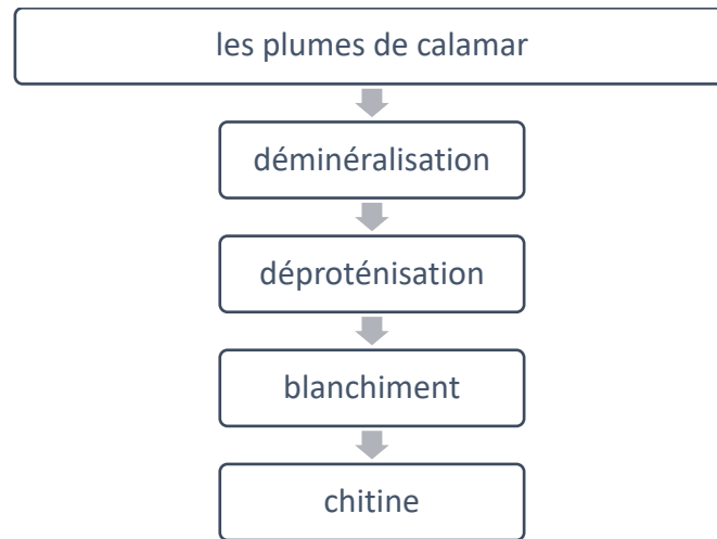
Figure II-1 : les étapes de l'extraction de la chitine (Laribi et al, 2022).
