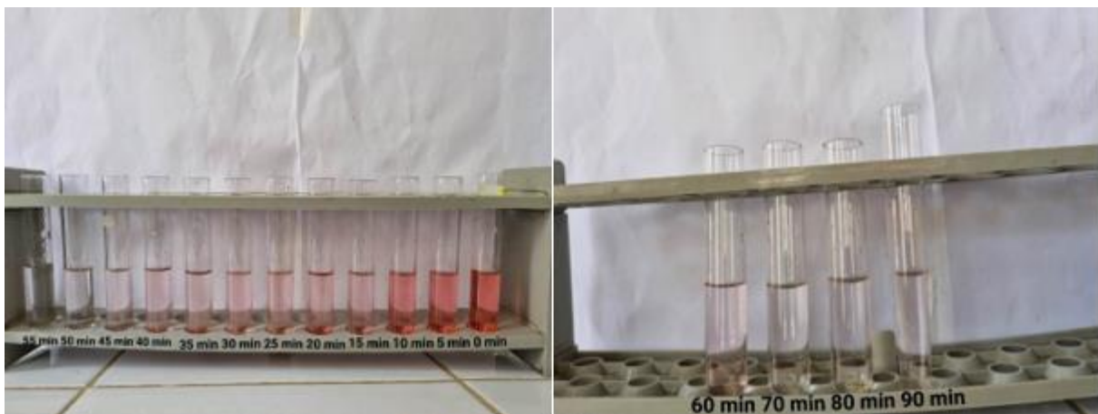
Figure 3 . 11: Adsorption de safranine (C = 10 ppm ; V= 200 ml ; pH= 6.5 ; T°= 25°C) avec Chaze (m= 20 mg et 60 mg)
