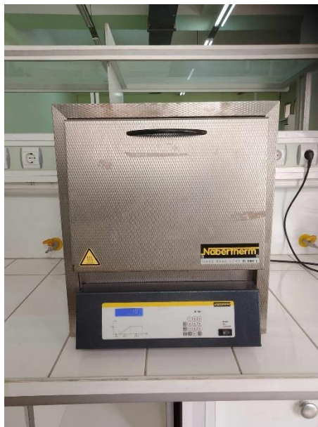
Figure 2 . 3: Le four utilisé dans la calcination
