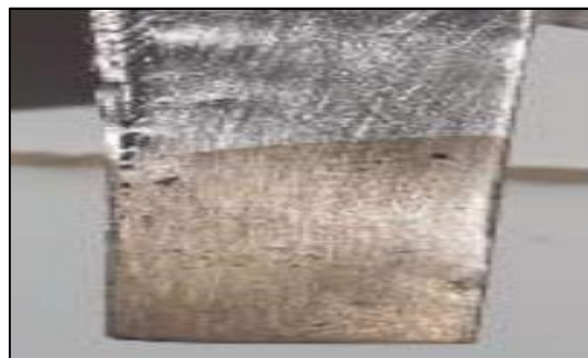
FigureIII.25 : Electrode de travail après l'électro-polymérisation du monomère synthétisé (dépôt du film de PANI).
