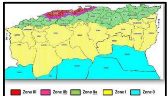
Figure 3.13 : carte classification sismique S : carte nationale de recherche appliqué en génie parasismique
