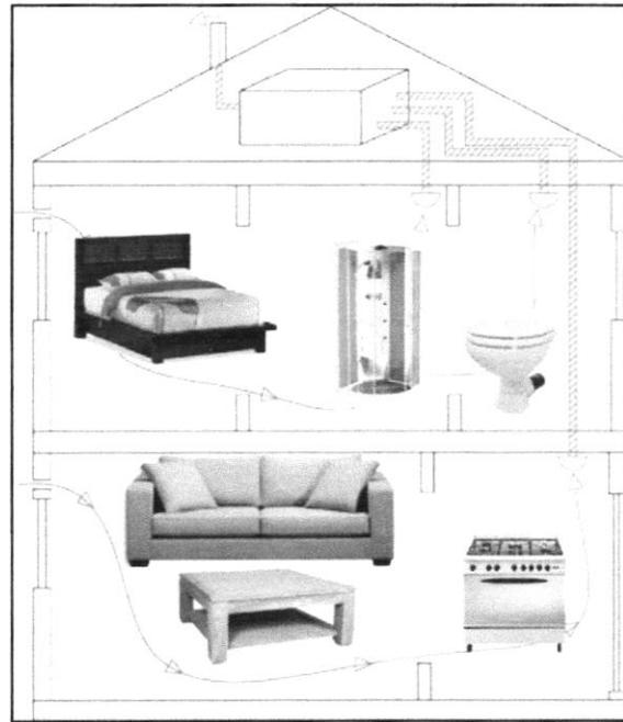
Figure 19 : principe de la ventilation mécanique ; "La ventilation des habitations - 1ère partie : principes généraux", NIT 192, Juin 1994.
