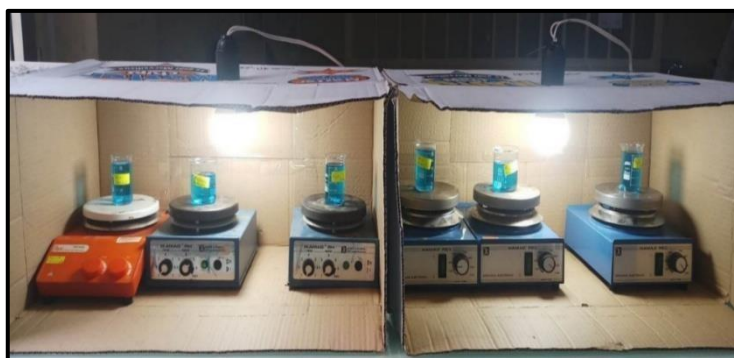
Figure .18 : Chambre de dégradation
