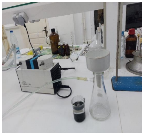
Figure 4. Lavage par l'eau distille jusqu'à pH=6.
