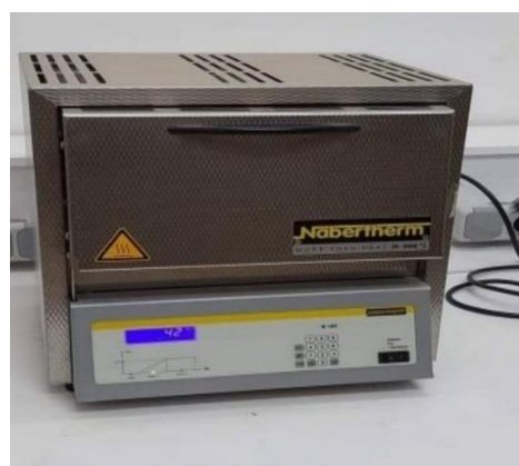
Figure 2. Four de pyrolyse (durée 3h avec une vitesse de chauffage de 10 °C/min.
