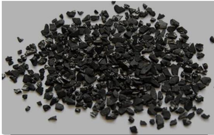
Figure 9. Charbon actif granulé.
