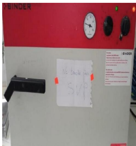
Figure 5. Sécher du biochar pendant 24h à 110°C dans une étuve.
