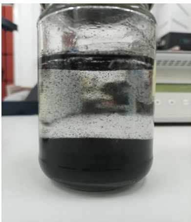
Figure 3. Immersion dans la solution de 0.1M HCl pendant 24h.
