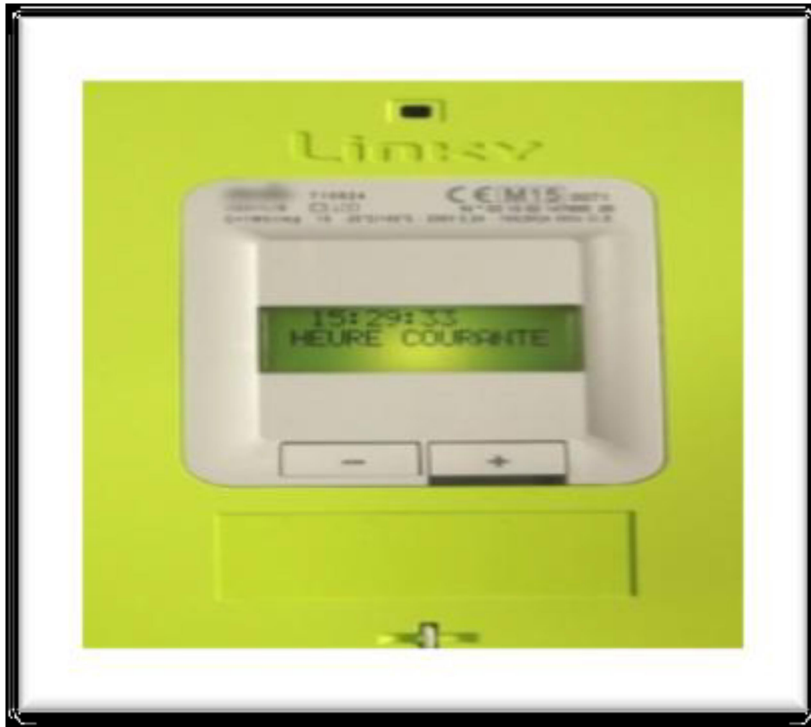
Figure 5 : Présentation de Compteur Edf Linky
