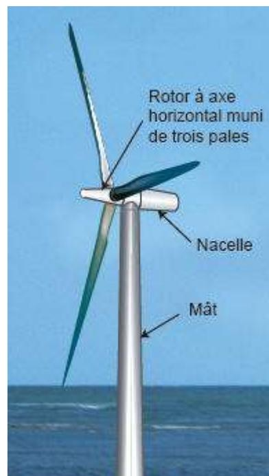
**Figure 2.6 :** Les composants d'une éolienn
