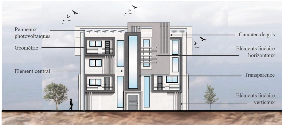
Figure 101: lecture de la façade de l'habitat semi collectif (Type A). Source : auteur
