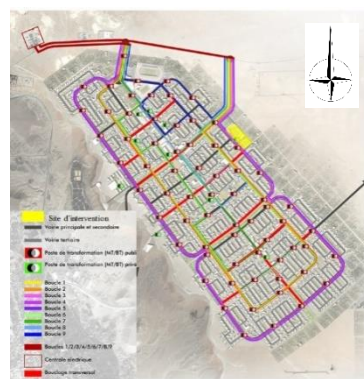
Figure III- 57 Alimentation du site en électricité
