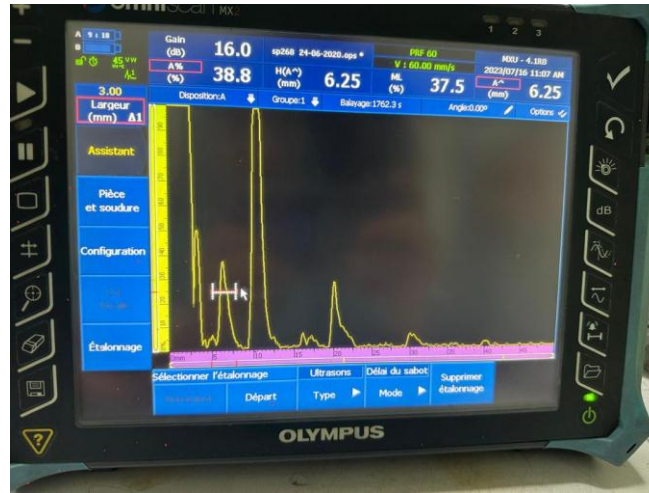
Figure III.9 : Le test ultrasonore de la profondeur 3mm
