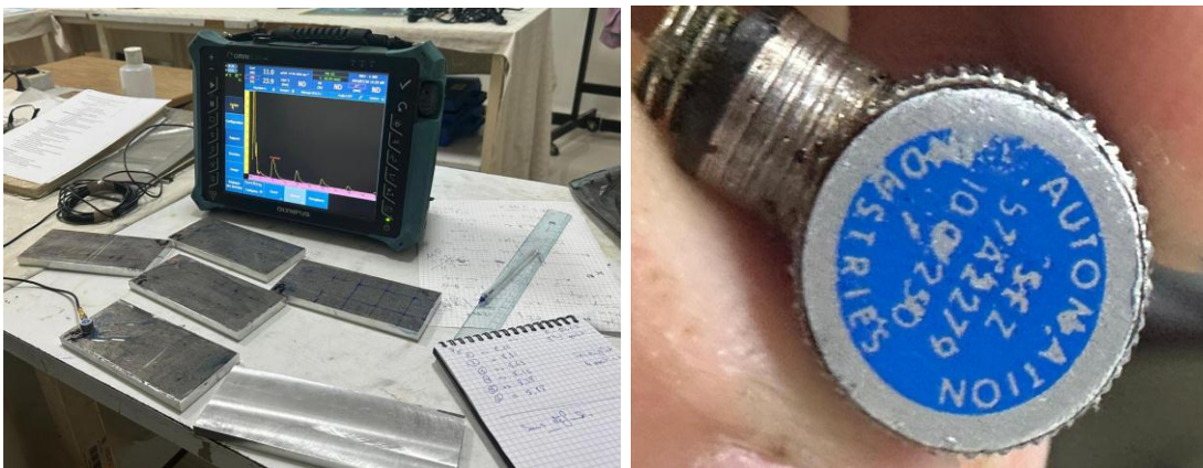
Figure III.8 : Olympus Omniscan MX2 & la sonde utilisée
