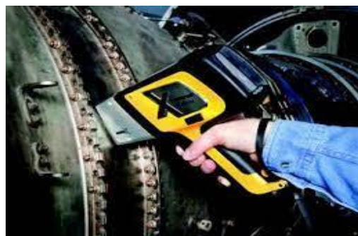
d) Inspection de CND des turbines
