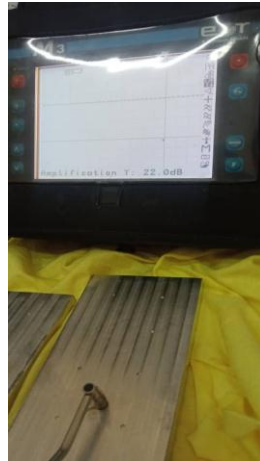
Figure III.5: Contrôle des défauts par Elotest M3
