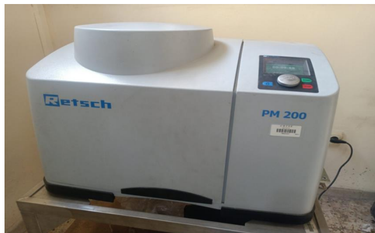
Figure. 2.13: Broyeur planétaire de type (Retsh PM 200).
