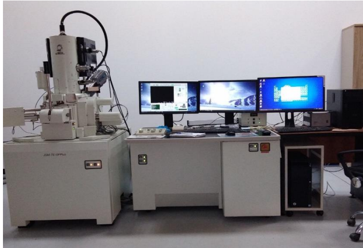
Figure2.2 : Microscope électronique à balayage JEOL JSM – 67610plus (CRTSE).
