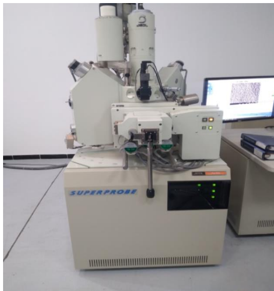
Figure 2.7: Microanalyseur a sonde électronique JXA-8230 (CRTSE).
