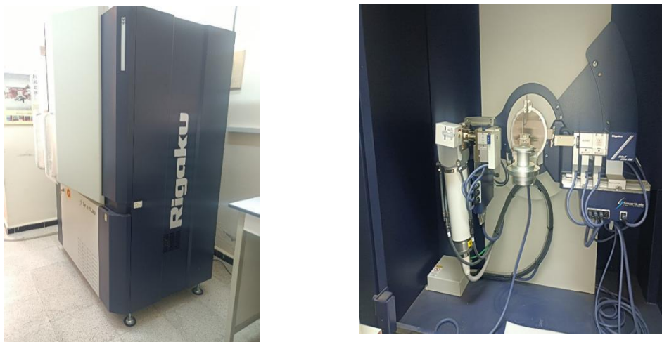
Figure 2.11 : Diffractomètre à rayon X Rigaku (USDB1).
