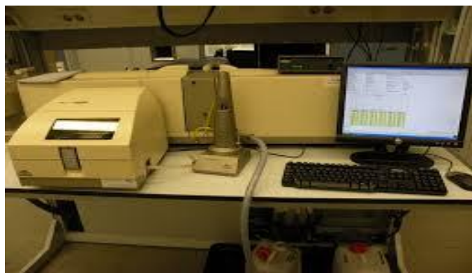
Figure 2.9 : granulométrie laser marque Malvern Mastersizer 2000, Hydro 2000 MU [53].
