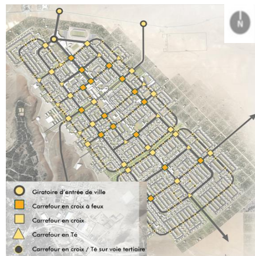
Figure 38 : Typologie des intersections de la ville d'El-Menia Source : ALG01-Mission B- El Menéaa, EGIS
