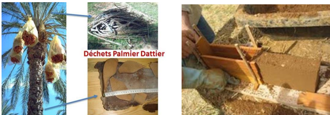
Figure 94 : bois de palmier dattier Source : Nouveaux matériaux biosourcés à base de bois de palmier dattier pour l'isolation thermique
