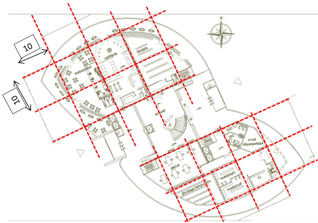
Figure 81 :Trame structurelle de projet Source : les auteurs
