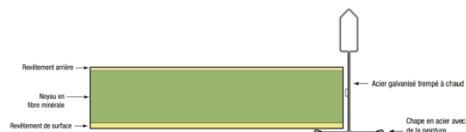
Figure 93 : Détail de faux plafond Source : Panneaux de plafond Fine FissuredMC Fibre minérale
