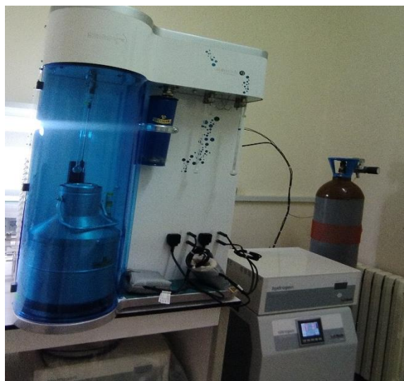
Figure III.10 . Image de l'appareil de physisorption de N 2 (Quantachrome INSTRUMENTS).
