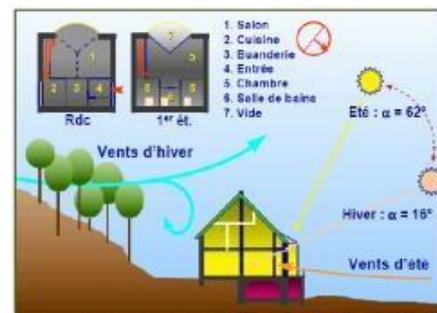
Figure 9 : L'implantation tient compte du relief, des vents locaux, de l'ensoleillement.
