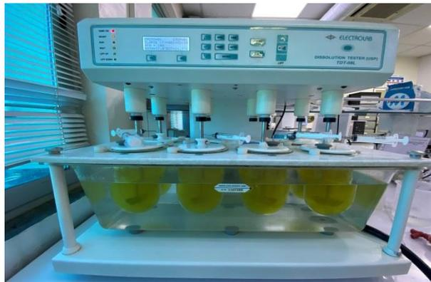
**Figure III.5 :** Appareil de dissolution a palette [12].
