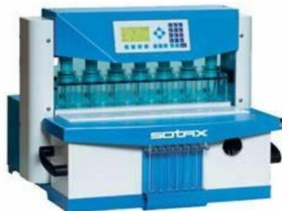
**Figure III.7 :** Appareil de dissolution à cellules flux continu.
