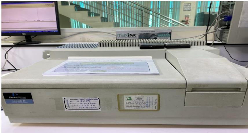
**Figure III.3** : Spectrophotomètre UV-visible
