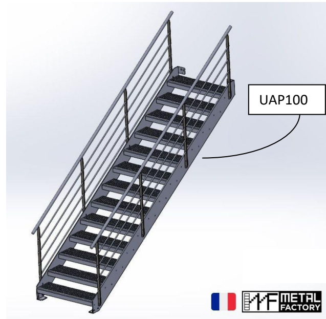
Figure IV.6 : limon de volée UAP100[12].
