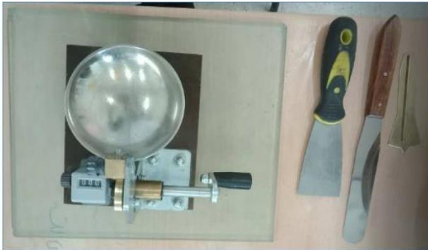
Figure 1.11 : Appareillage de Casagrande.
