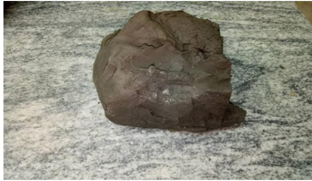
Figure2.2 : Argile grise prélevée de la région Tessala El-Mardja, wilaya d'Alger.
