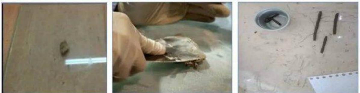
Figure 1.12 : Préparation du rouleau pour la détermination de \omega_L .
