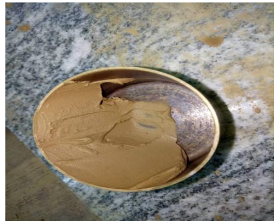
Figure2.9 : Remplissage de la coupelle métallique.
