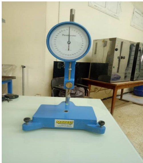
Figure 2.6 : Appareil de FCT utilisé avec cône de 80g et 30°.
