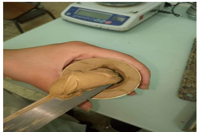
Figure2.12 : Prélèvement du sol pour mesurer la teneur en eau.
