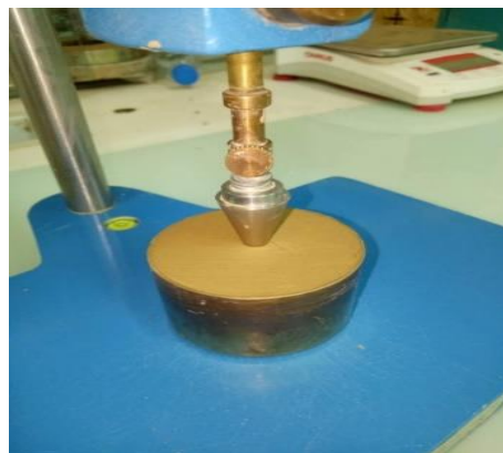
Figure 2.11 : Enfoncement du cône dans le sol.
