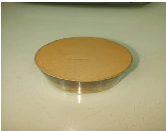
Figure2.9 : Remplissage de la coupelle métallique.
