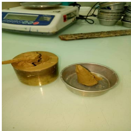
Figure2.12 : Prélèvement du sol pour mesurer la teneur en eau.
