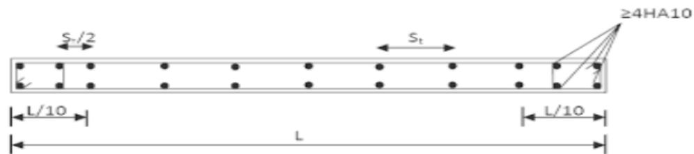
**Figure V. 7:** Disposition des armatures verticales dans le voile.
