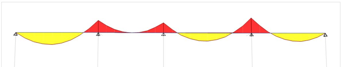
**Figure III.13 :** diagramme de moment fléchissant à ELU.
