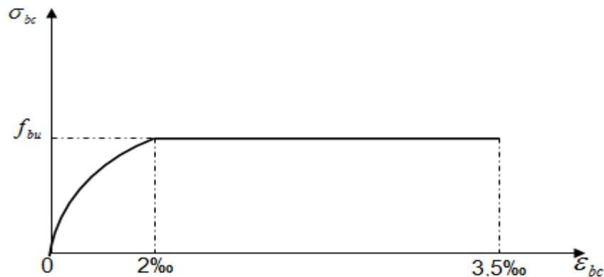
**Figure I. 9:** Diagramme contrainte- déformation du béton.
