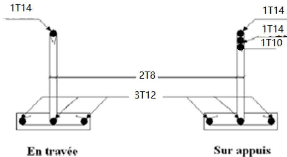
**Figure III. 11:** Ferrailage des poutrelles en Travée et en Appuis.
