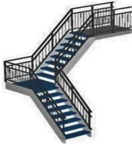
Figure 1.3: Escalier en charpente métallique.
