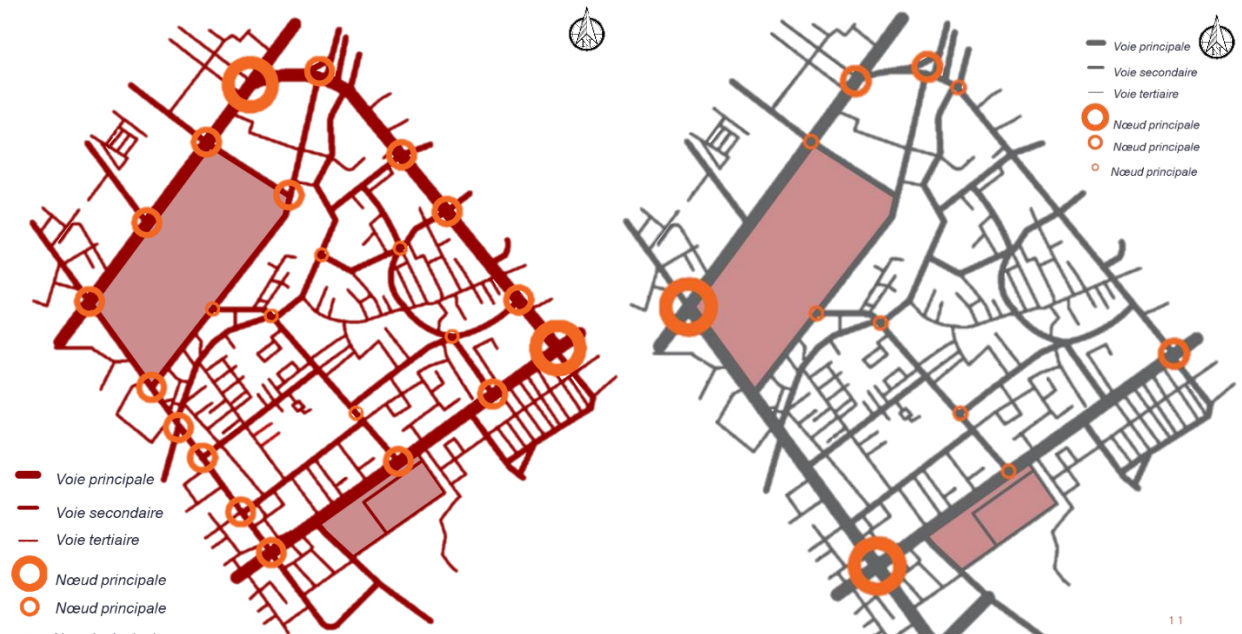
Figure 137 Hiérarchisation physique du système voirie du site d'intervention / Hiérarchisation sensorielle du système voirie du Site d'intervention Source : Auteur
