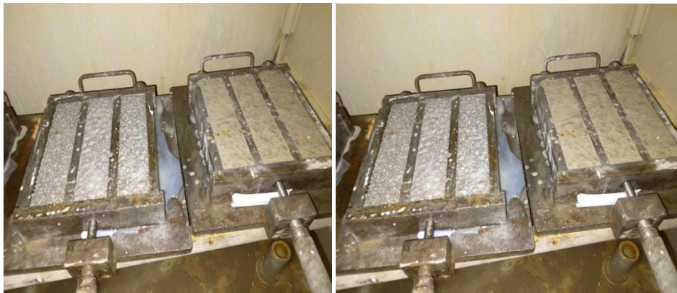
Figure 4.3 : problème d'écoulement (manque de pâte)
