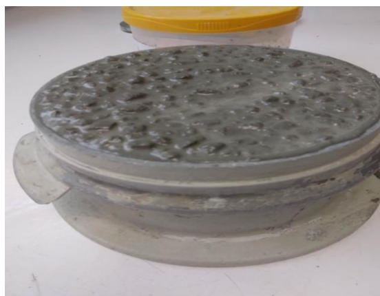
Figure 2.7 : le moule de densité
