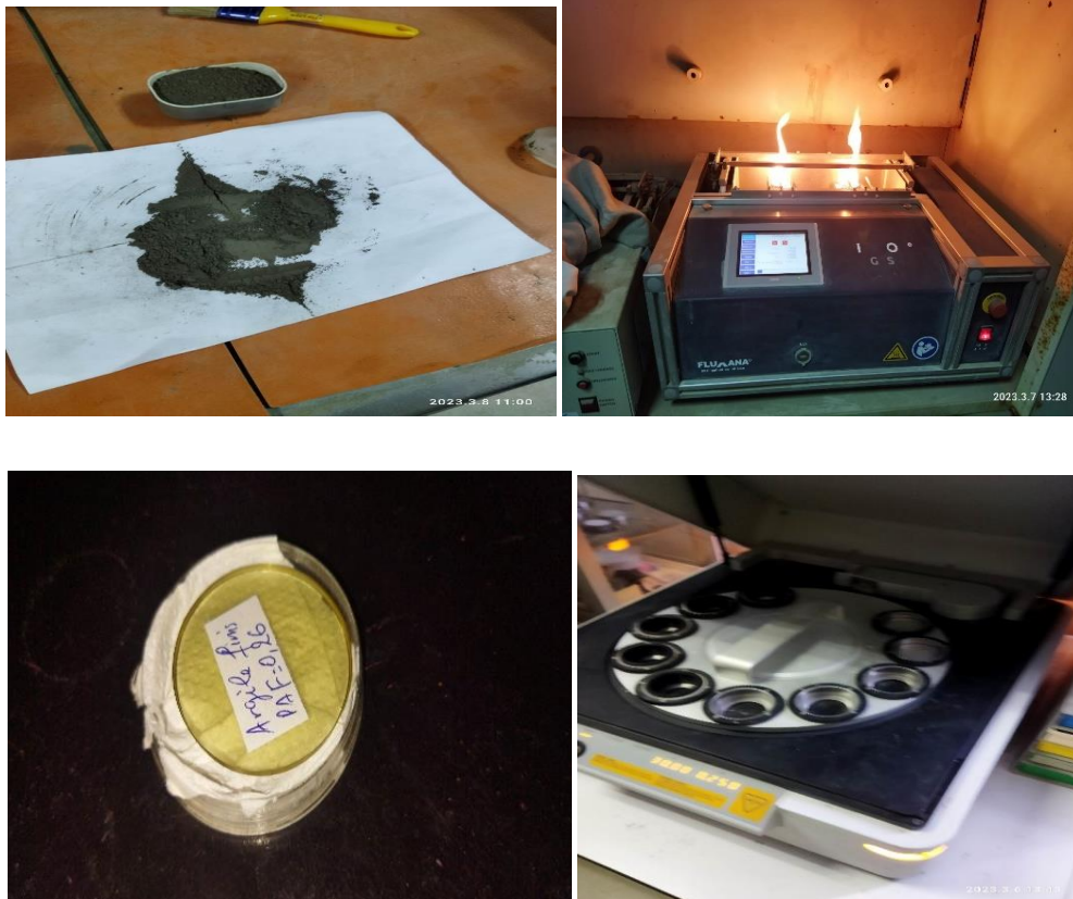
Figure 4. 2 : Essai XRF pour l'argile expansée.
