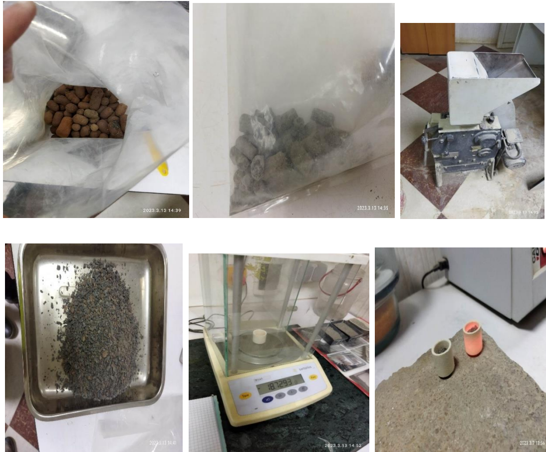
Figure 4.1 : Détermination de la perte au feu.
