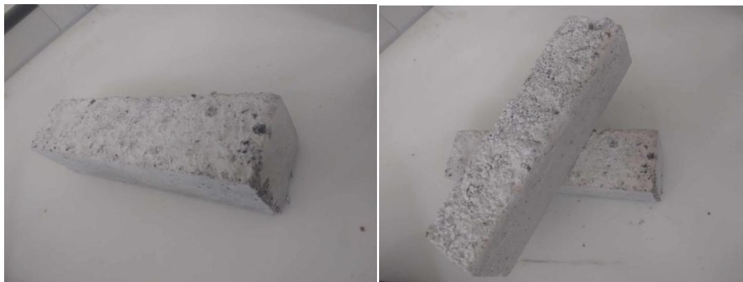
Figure 4.4 : ségrégation apparente après démoulage
