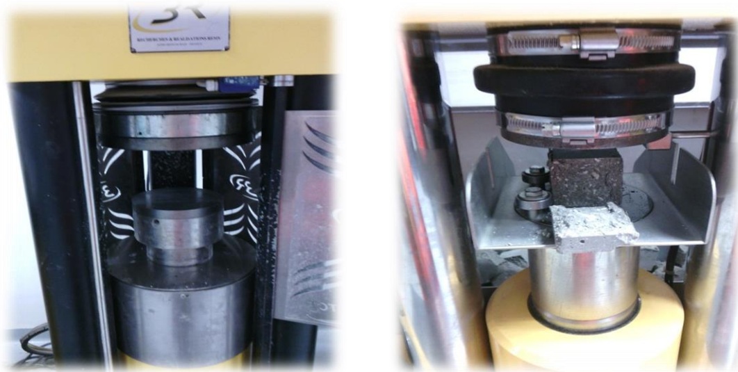
Figure 2. 11 : Essais de la résistance à la compression.
