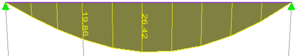
Figure III.7 : Diagramme des moments fléchissant à L'ELS.
