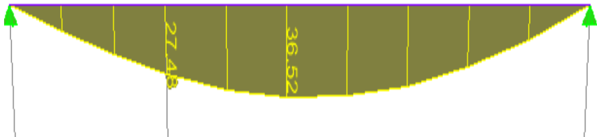
Figure III.6 : Diagramme des moments fléchissant à L'ELU.
