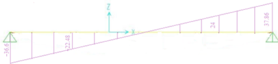
Figure.III.11 : Diagramme du Moment fléchissant à L'ELS
