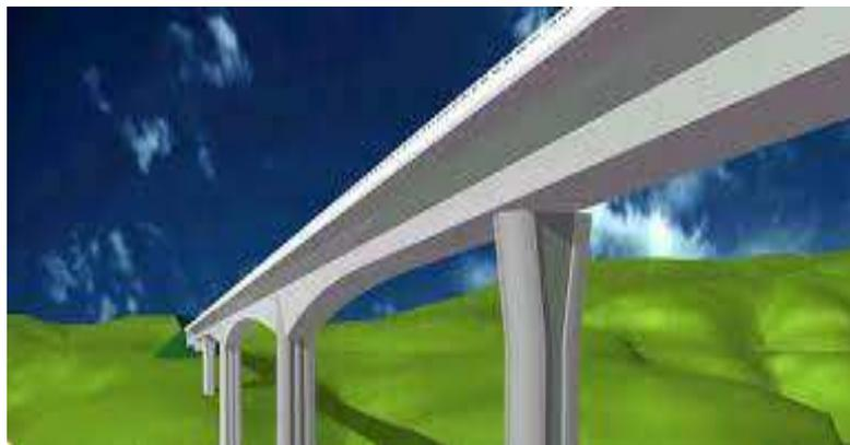
Figure I. 13: Pile encastrée dans le tablier [1]
