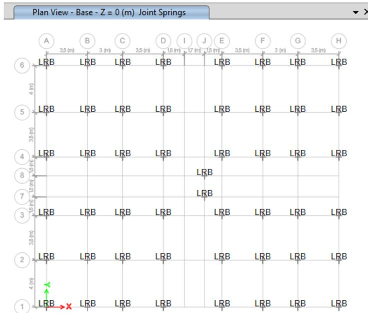
Figure IX 63: Vue en plan de bâtiment isolée (vue en base).
