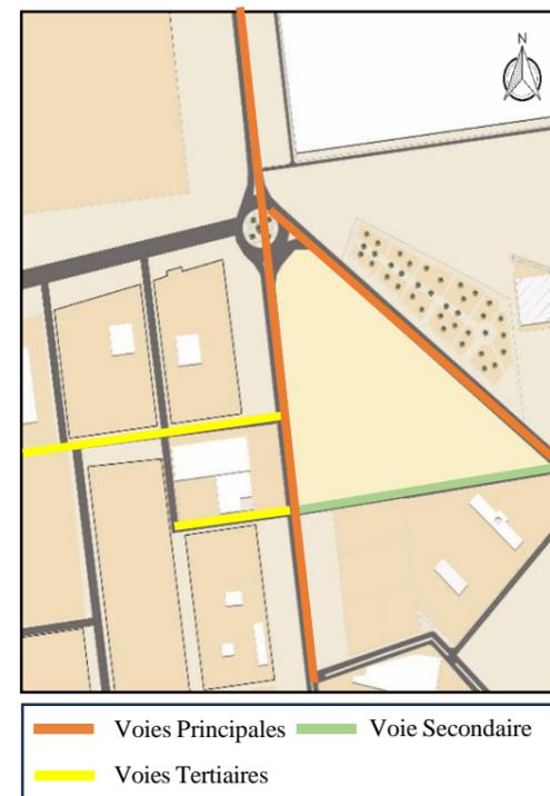
Figure 1-7 : Schéma de la hiérarchie des voies
