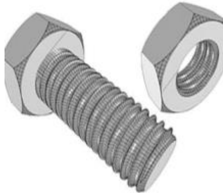
Figure II. 8 boulon de classe 8.8
