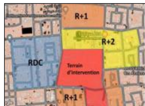
Figure 98 : gabarit autour de terrain d'intervention
