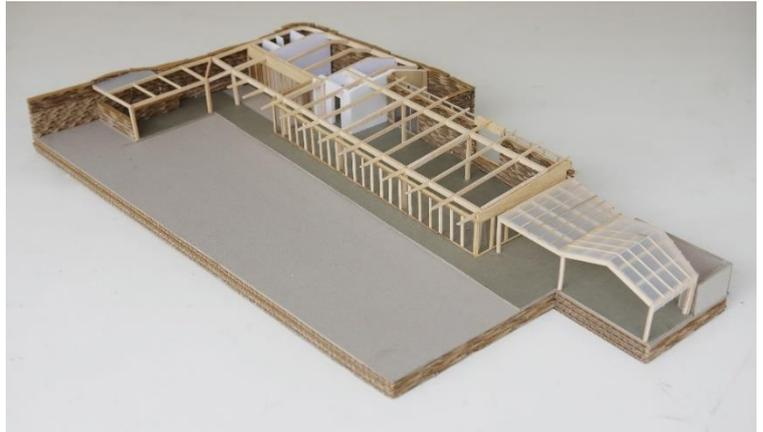
Figure 64: Maquette de l'ossature du restaurant
