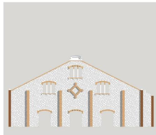
Figure 88 : Appareillage et disposition pierre/brique sur un mur en pierre
