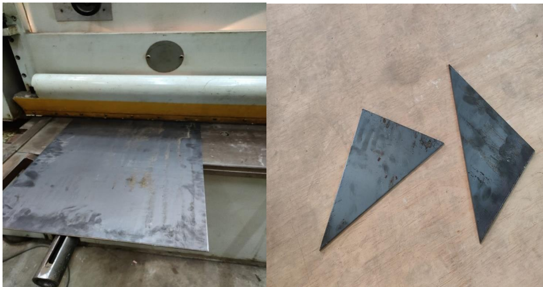
Figure 4.11 :coupage des support étagère pour le bac d'eau 1
