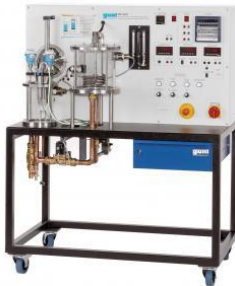
Figure 4.4 : Banc d'essai des techniques de mesure de niveau et de la température
