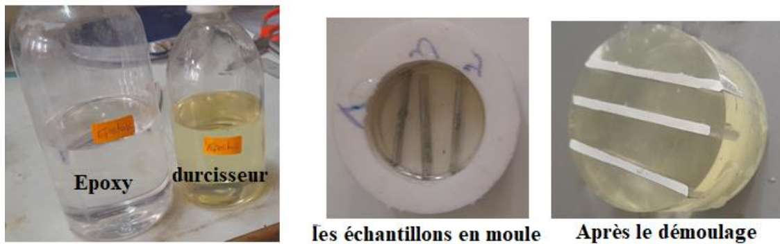
Figure 2.7 Processus d'enrobage à froid
