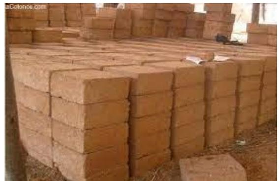
**Figure216 :** brique de terre stabilisée.
