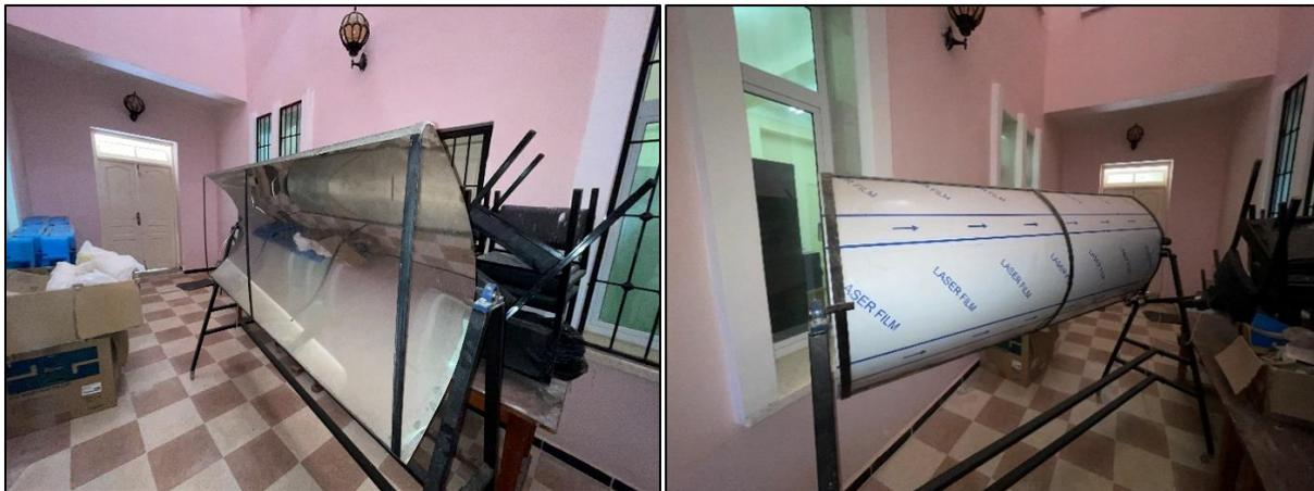
**Figure II.9** - Collecteur cylindro-parabolique au niveau de l'Université Saad Dahlab, Laboratoire 13 du pavillon 13.
