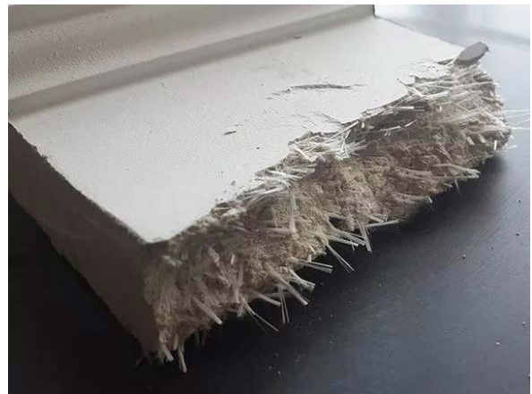
Figures 136 : Le béton renforcé de fibre de verre (GFRC) Source : https://decorexpro.com/beton/fibrobeton/ .
