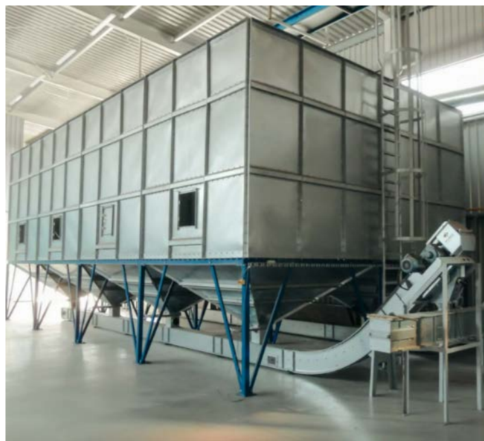
Figure01 : Silos pour le stockage des céréales les cellules carrées modulaires
