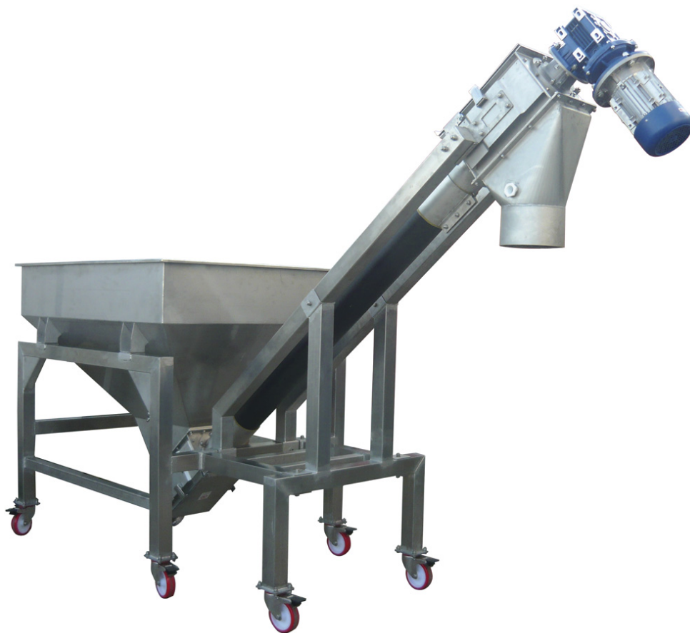
Figure20 : Convoyeur à vis sans fin avec trémie.
