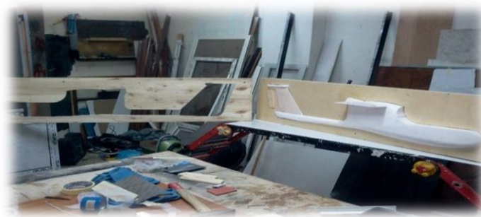
Figure (IV-26).Cadre de centrage et renforcement de moule.
