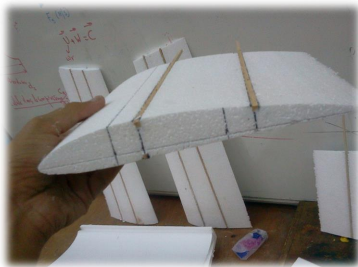
Figure (IV-16). Collage du longeron sur les ailes.
