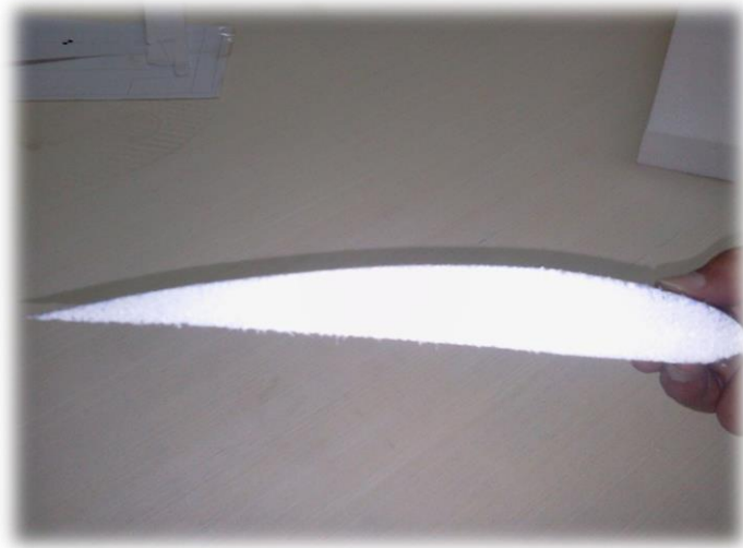
Figure (IV-13). Génération de profile avec la machine de découpe manuel.
