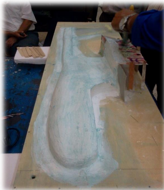
Figure (IV-30). Application de la cire de démoulage.
