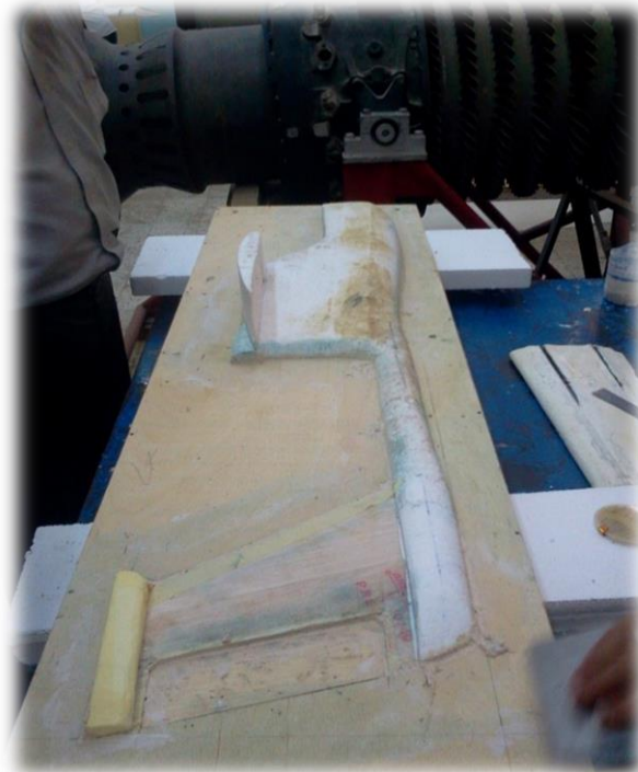
Figure (IV-28). Remplissage de vide avec le plâtre.
