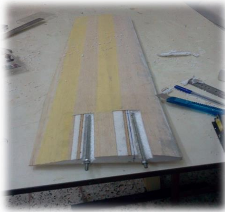
Figure (IV-21). fixation des ailes avec le fuselage avec des tiges filté en aluminium.
