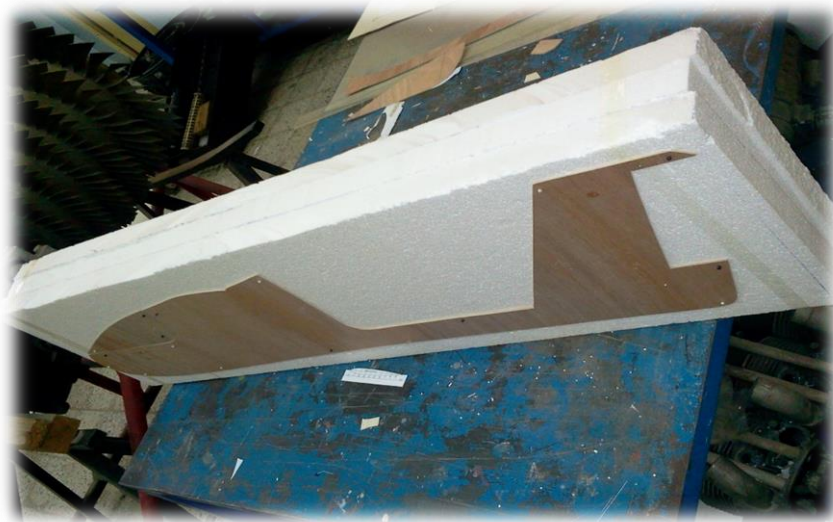
Figure (IV-2). Fixation des gabarits pour le découpage latérale du fuselage.
