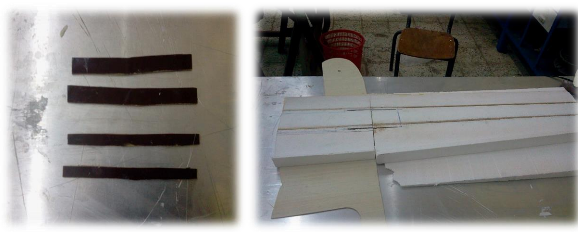
Figure (IV-17). Fixation des ailes avec des clés de jonction en Bakélite .
