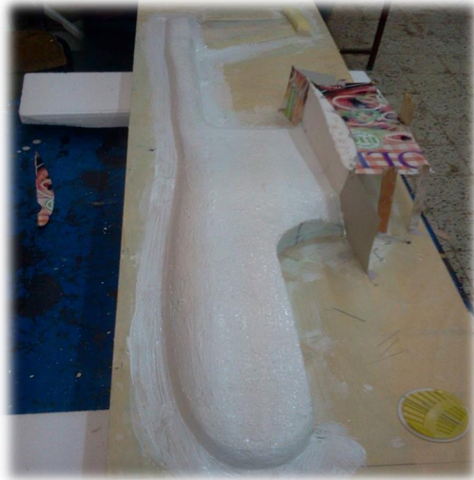
Figure (IV-29). Application des couches de vinyle.
