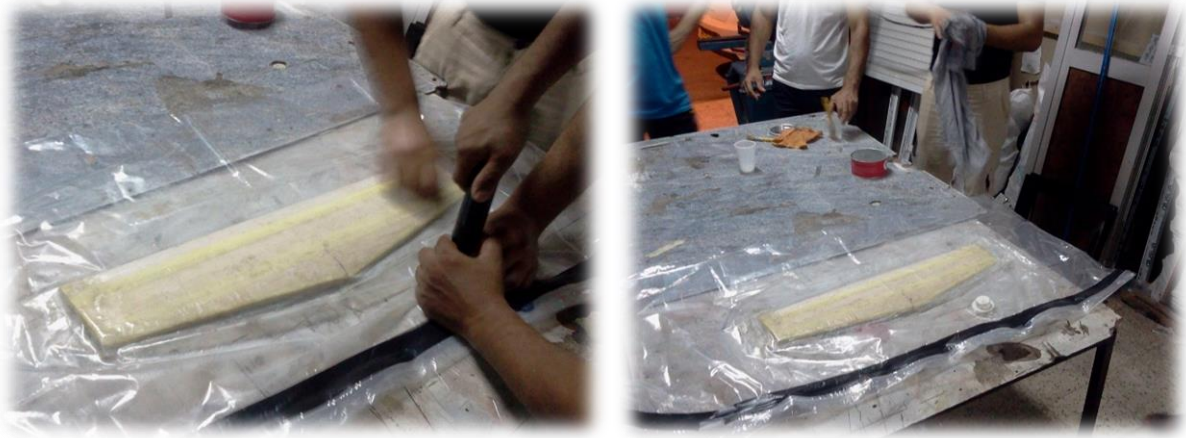
Figure (IV-24). Revêtement d'empennage par le composite.
