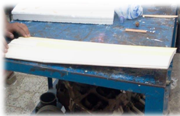
Figure (IV-20). Revêtement des ailes en balsa.
