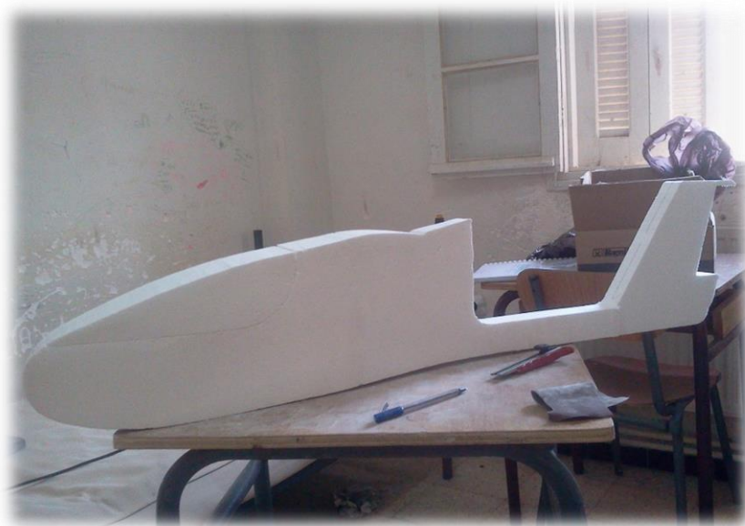
Figure (IV-5). Forme de fuselage obtenu par la découpe avec la machine découpe manuel.
