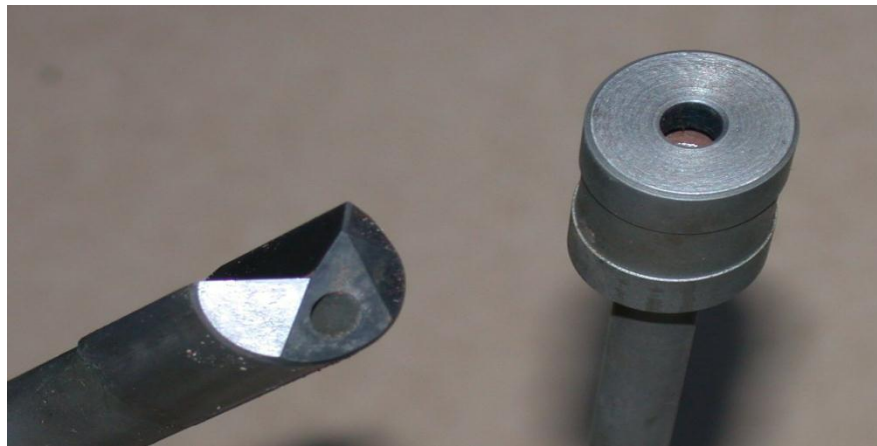
figure.2.8 l'outil de perçage profond (forage).
