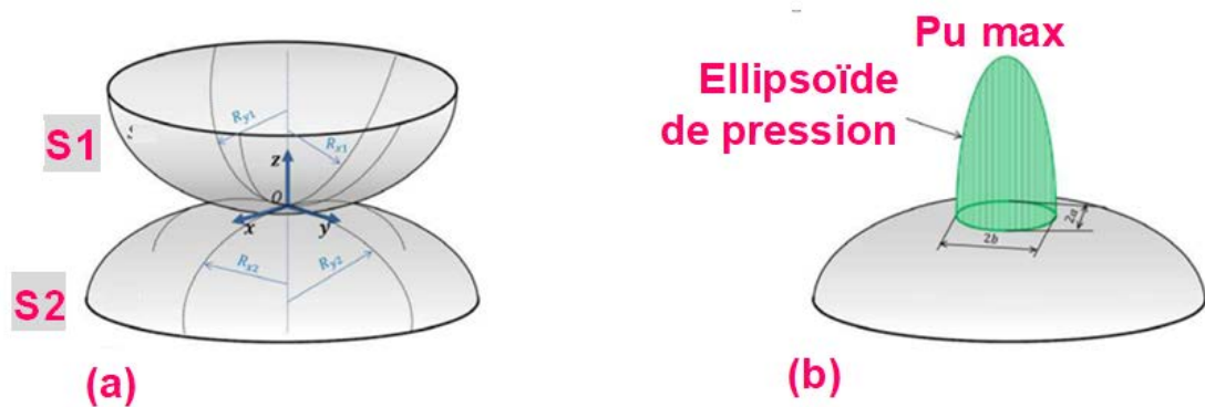
Figure 3. 3 : (a) Rayons de courbure des corps en contact (b) Aire de contact et de distribution de la pression selon la solution de Hertz
