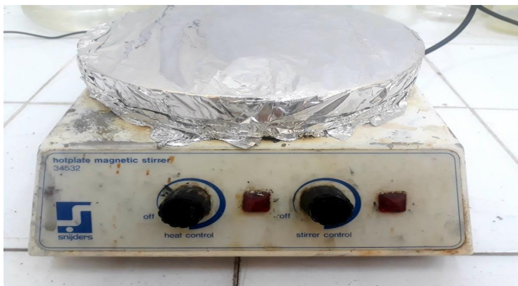
Figure14: agitateur magnétique utilisé pour la dispersion de C-TiO 2 dans la résine époxy.
