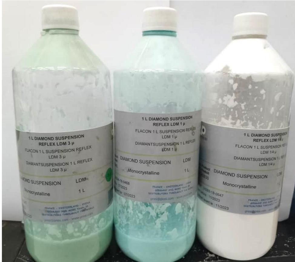
**Figure III.8 :** Les solutions diamantées de (0,25, 1 et 3 μm)
