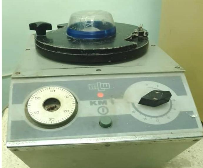
**Figure III.3:** broyeur à boulets (MLW-Allemagne)
