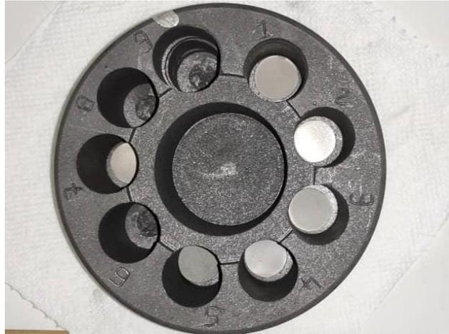
**Figure III.5 :** port échantillons en graphite
