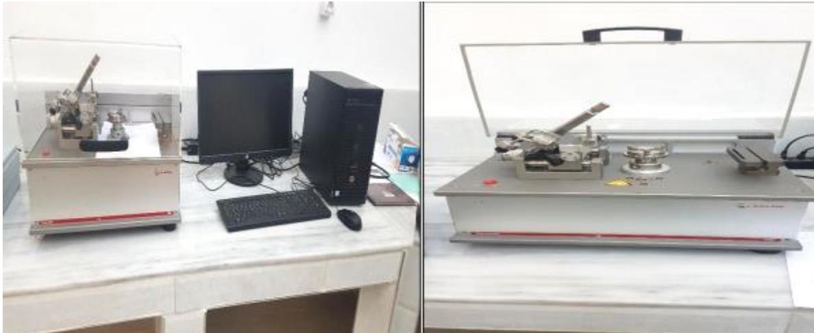
**Figure III.12** : tribomètre type ANTON PAAR TRB3 CSM, switzerland.
