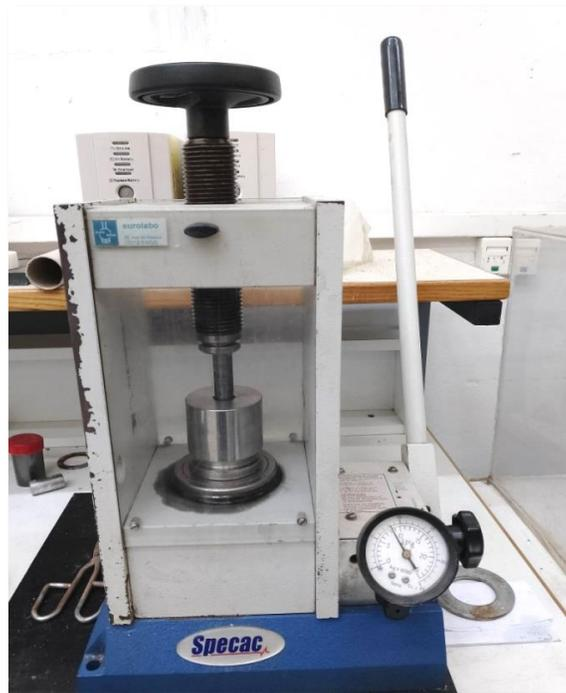
**Figure III.4 :** Presse hydraulique uniaxiale de type SPECAC
