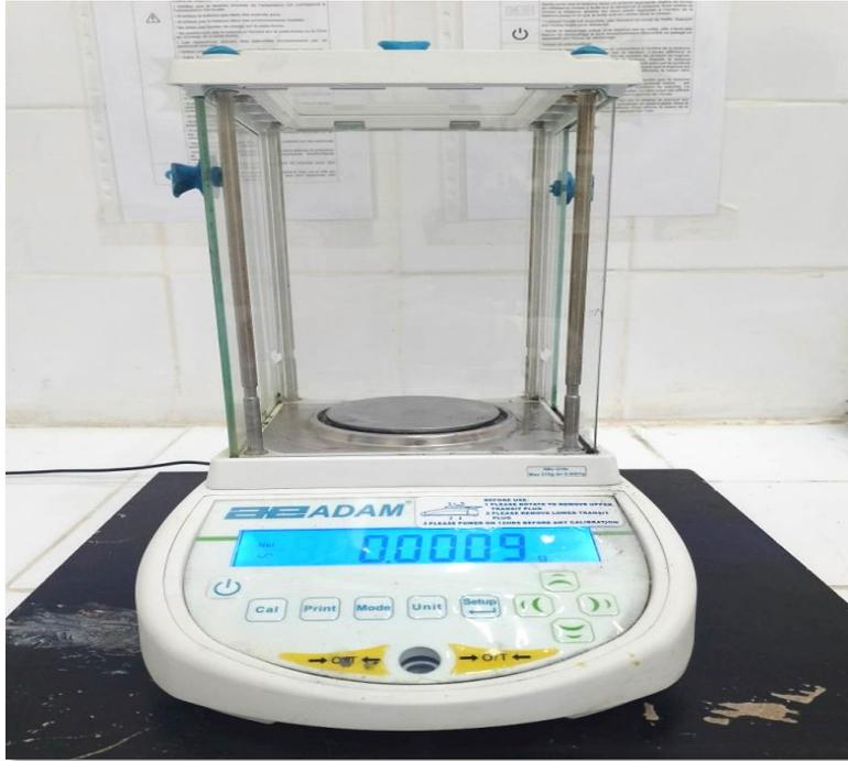
**Figure III.2 :** Balance de précision  $10^{-4}$ g
