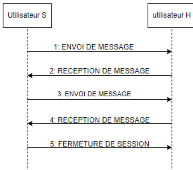
Figure III.13: Diagramme de séquence pour les messages
