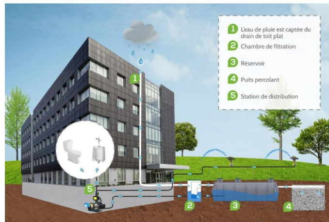
Figure II-32: récupération des eaux pluviales, .source : http://econeau.com/wp-content/uploads/2016/02/schema-commercial.jpg consulté le 30/01/2018
