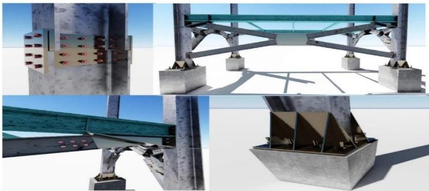
**Figure VII. 1:** Exemples des assemblages boulonnés.
