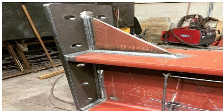
**Figure VII. 2:** Exemples des assemblages soudés.
